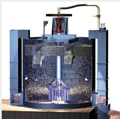
Celdas Convencionales Mecánica
