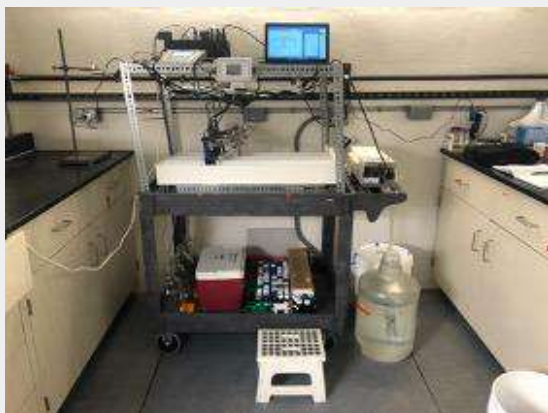
Sistema completo con bombas, fuente de agua/reservorio, luces, etc
