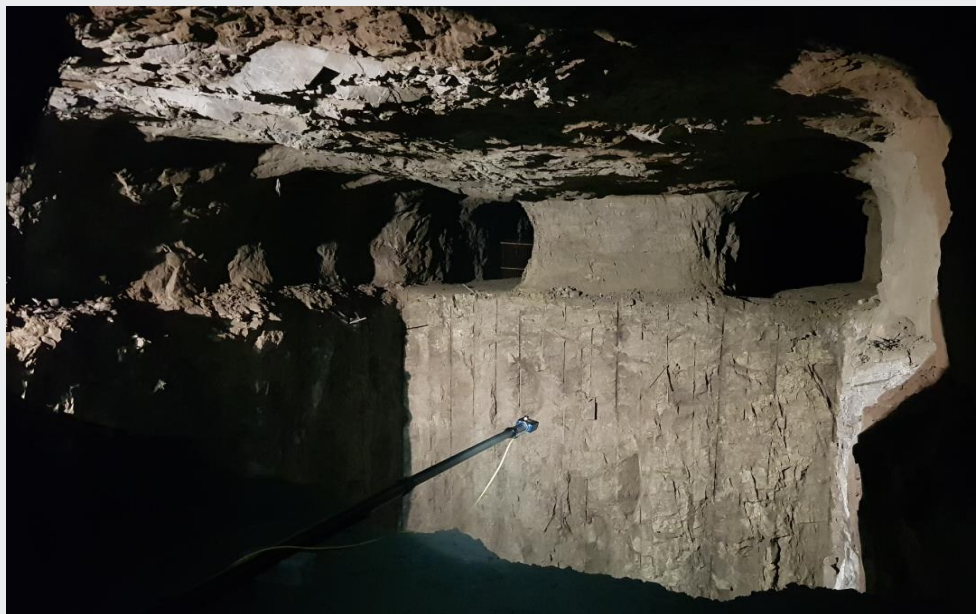
Exposición de caras con voladura controlada
